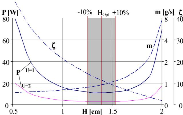
Fig. 4: Effect of fin height  $H$  on fan power  $P$ :
